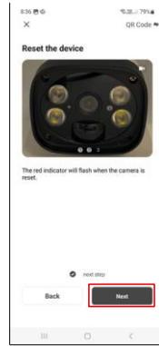
Introduza as pilhas na câmara e ligue-a. Recomendamos que reinicie sempre a câmara. Um LED vermelho intermitente indica que a câmara está pronta para o emparelhamento.
